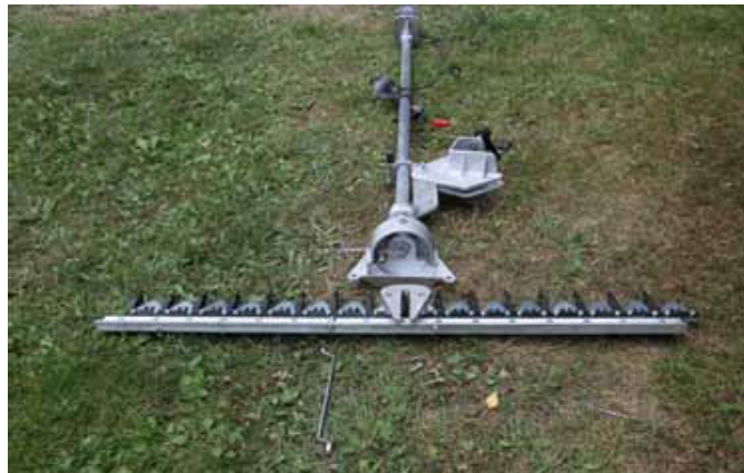
↑ Leikkuri on helppo kasata. 120 cm leveä leikkuupää kiinnitetään pystyputkeen muutamalla pultilla.
