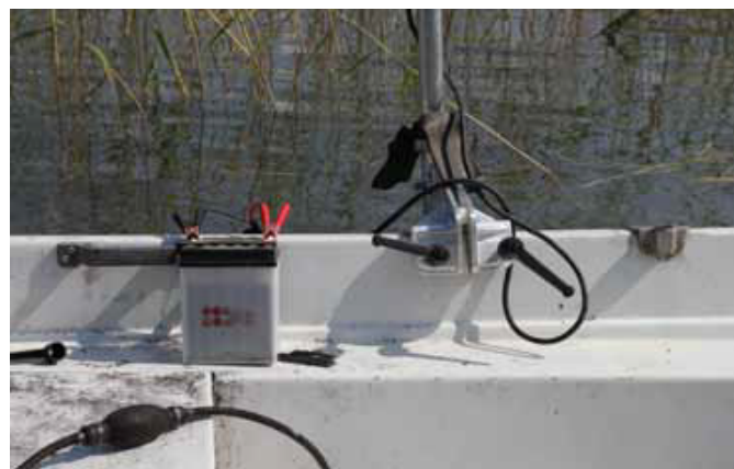
↑ Laitaan kiinnitettäessä paine aiheutuu varsin pienelle alueelle, mikä rasittaa laitaa huomattavasti. Akkusuositus on 12v ja 20 Ah.
